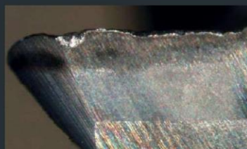
Après 8h d'usinage (Aluminium 2024) After 8h of machining (Aluminium 2024)
